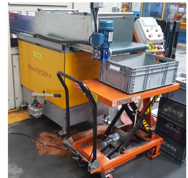
Transportador de tapete inserido em carris e montado em elevador para ajuste da posição em função das peças a recolher; Permite afinar a profundidade e altura. Pode ser construído em aço, inox ou alumínio.
