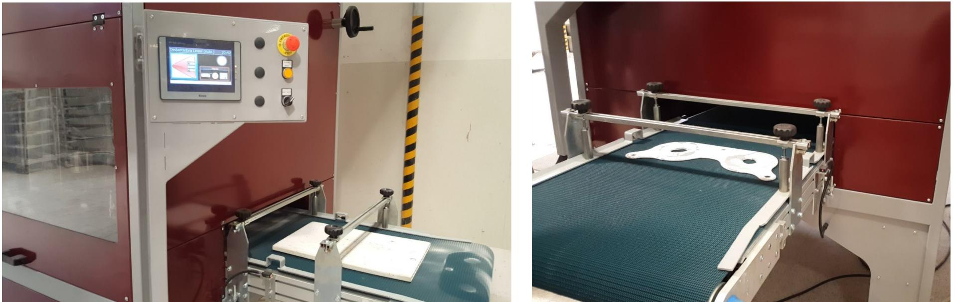
Este equipamento poderá ser integrado com outros equipamentos assim como linha de engobagem automática, robotização de alimentação e recolha das peças e tornar todo o processamento de placas refractárias semi automático ou completamente automático e isento de mão de obra.
